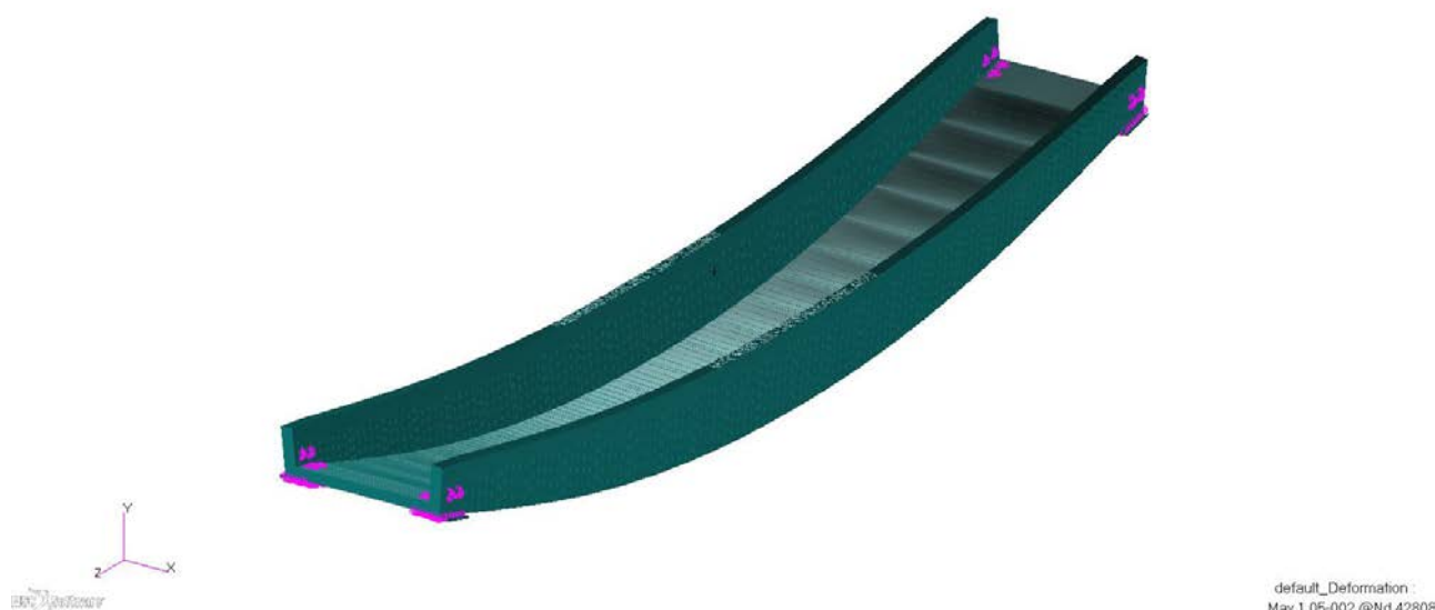
Рис. 4.38 - Форма и значения прогиба мостового пролёта (максимальное значение 10.5 мм)
