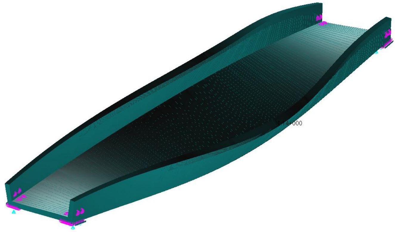
Рис. 4.36 - форма потери устойчивости конструкции пролётного строения (запас по устойчивости составляет 7,7)
