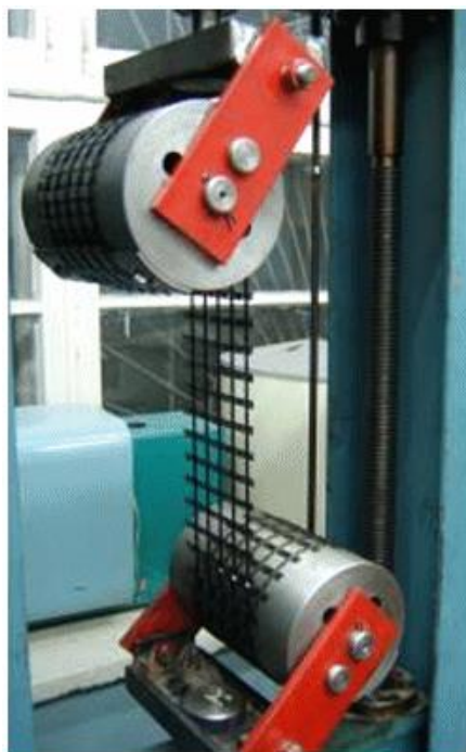
Рис. В.1 Определение предела прочности ГМ при растяжении
